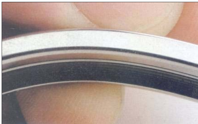
Vernikkelde rail kan extreem sterk gebogen worden. De nikkellaag blijft zich hechten aan de rail. Ook werktuigsporen dringen niet tot het messing door.
