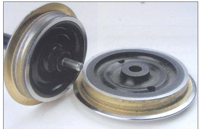
Deze wielen hebben dienst gedaan op een demonstratiebaan welke bestond uit edelstaalrails. De gebruikte bochten waren van de radiussen R1 en R2. Zij hebben garant gestaan voor de slijtage
