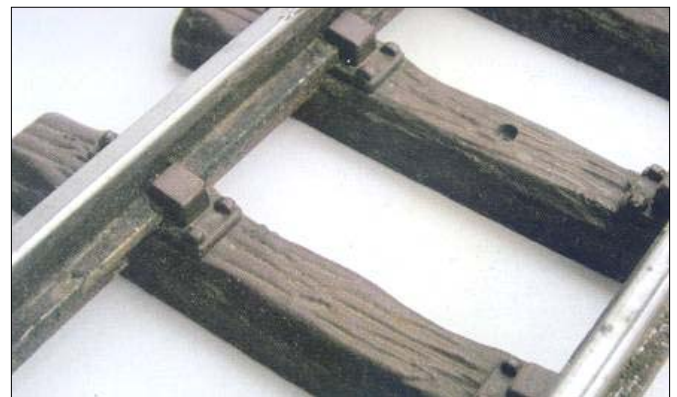
Een voorbeeld van een vernikkelde Thiel rail welke 27 jaar lang bereden is en buiten heeft gelegen, laat weinig verschil zien.
